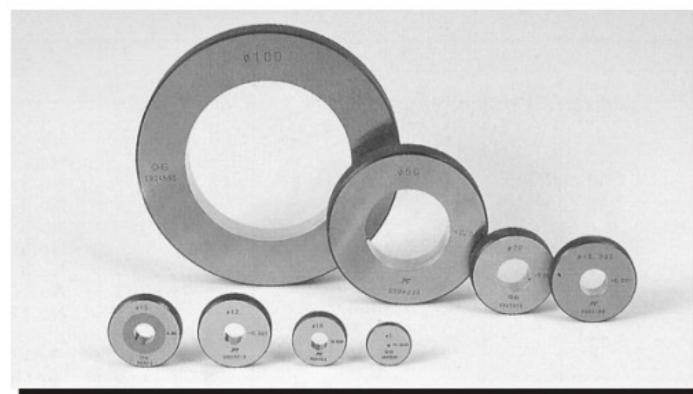
基准光面环规，是被用来做为测定仪的基准的量规，用做精密测定仪的基准的，是根据JMAS(日本精密测定机器工业会规格)其中，量规部分的圆度，圆筒度，直径的允许值都被规定的。光面环规的尺寸和实际测量值，都被刻在上面。
