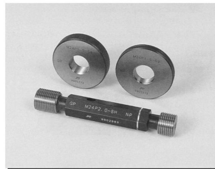
平行螺纹量规量一般的方式是极限式。利用量规的通、止规管理产品螺纹的极限，保证精确度。极限式量规大致可以分为ISO等级测量方式和以前的JIS等级测量方式。以前的JIS测量方式是在量规的止端有检查用和加工用的区别。ISO测量方式则没有这样的区别，它完全被简单化了。测量外观用的卡规也是一样的。具体使用方法为界限螺纹量规的通可以轻松穿过，止规的螺纹拧进不到2圈的话，这样测量等级则是合格的。
