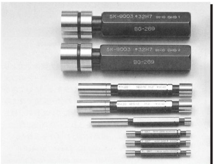
光滑极限塞规是一种具备以孔的最大实际尺寸为基准的测定面以及量小实际尺寸为基准的测定面的一种量规。
