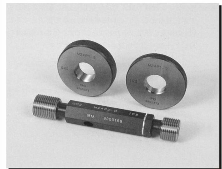
极限量规是被决定着所要测定的螺纹等级和相同量规的等级。该量规是通过使用通止两端有尺寸差异的螺纹，来检查螺纹部件预先所规定的尺寸精度的最大限度及最小限度，所以被叫做极限量规。使用方法为：极限量规的通规可以轻松穿过，止规拧进最多不能超过2圈，若如此检查结果判定是合格的。我公司，除了大量生产JIS规格的界限螺纹量规之外，其他所有规格的螺纹量规也设计生产。
