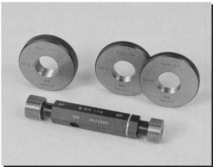
该产品是在导入ISO规格之后按照JIS标准所生产，用于检查不要求密封性的机械连接为主要目的的螺纹。和以往的管用平行螺纹量规的相差点如下：体使用方法为界限螺纹量规的通规可以轻松穿过，止规的螺纹拧进不到2圈的话，这样测量等级则是合格的。
