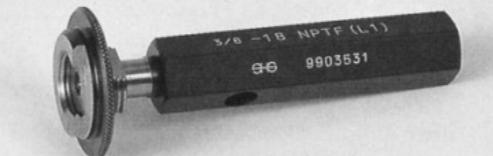
该产品是符合美国规格的锥形螺纹量规(ANSI)，NPTF是被应用于轮船，汽车，飞机等的燃料，供油管等的结合，即使不用普通的粘贴材料也能保证充分的密封性。NPTF螺纹量规检查手握紧部分L1螺纹插头塞规，L1螺纹环规检查和柄连接部分，而L3螺纹塞规，L2螺纹环规，对于产品螺纹的检查这两方面的量规都必须用到。该量规在基准位置有切口的量规和最大，最小界限这两个地方有切口的量规，但一般由子后者使用简单而在被大量使用。
