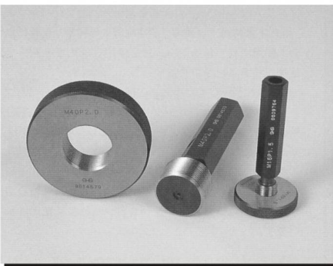
标准螺纹量规由一组相互精密配合的螺纹环规和螺纹塞规组成，此外被制作成接近于螺纹的基准尺寸，这种量规主要在直接与产品的螺纹镶嵌中使用。定期检查的时候是和塞规镶嵌为一对，能够检查螺纹环规的磨损程度。和产品的螺纹直接接触使用的时候，可以轻松通过产品螺纹的全长，轻松地拧进到极限的时候是松缓的而不是紧嵌合的话，说明被制作的螺纹就是粗糙的不合格的。另外，量规的磨损严重的话，即使与量规完全吻合的螺丝与螺帽也会出现咬不紧的情况，请充分注意量规的管理。
