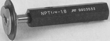
该产品是符合美国规格(ANSI)螺纹管塞规，在要求高密封性的一般零件的管用螺纹(NPT)的检查时使用。这种量规，可以测量各个断面，一般被使用最多的是测量小位置，基准位置，大位置的3个切口的量规。锥形管螺纹的测量用手拧进的时候，管的末端是量规的最大位置和最小位置的切口之范围内的话就判定为合格。此外，NPT是将螺纹顶部切下的高度来决定内外径尺寸，这种检查被推荐使用于NPT平面锥形量规。根据锥形螺纹量规的三处切口和平面锥形量规的六处切口的位置的吻合状况就很容易检查。
